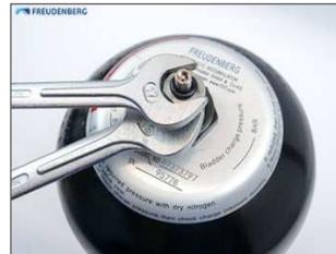
Lösen und Entfernen der Haltemutter mit gekonterten Gasventilträger (T2+T3).
