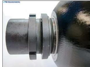
Die Nutmutter auf das Gewinde des Ventilgehäuses schrauben und handfest mit dem Distanzring verschrauben. Anschließend die Nutmutter mittels einem Hakensteckschlüssel und gekonterten Flüssigkeitsventilgehäuse drehmomentgesteuert nach Zeichnung, bzw. Vorgabe Kapitel. 4.1 verspannen.
