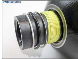
Den Distanzring über das Flüssigkeitsventilgehäuse schieben und seine Zentrierschulter im Spalt zwischen Behälter und Gehäuse positionieren.
