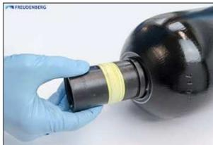
Die ölseitige Aufnahmebohrung erneut mit Schmierstoff benetzen. Den geteilten Zentrierring leicht zusammenfallen und möglichst Reibungsfrei durch die Aufnahmebohrung ins Behälterinnere ein-führen.
