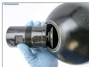
Entfernen der Blase durch die Behälteröffnung. Oberflächenbeschädigungen beim Herausziehen sind im Fall einer Wiederverwendung der Blase zu verhindern.
