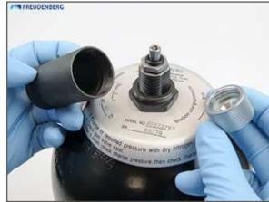
Druckentlastung der Speicherblase mit Hilfe der Prüf- und Füllvorrichtung. Die Hinweise des Kapitels 6.3 sind zu beachten.
