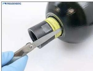
Den Kammerring (für Speicher ab 10 L), dann den O-Ring und letztlich den Stützring vorsichtig mit einem O-Ring-Heber (oder vergl.) über das Gewinde des Flüssigkeitsventils führen und im Spalt zwischen Behälter und Aufnahmemantelfläche des Gehäuses montieren. Die Ringe axial bis zum Zentrieren verschieben und dabei den O-Ring nicht verdrillen oder quetschen.
